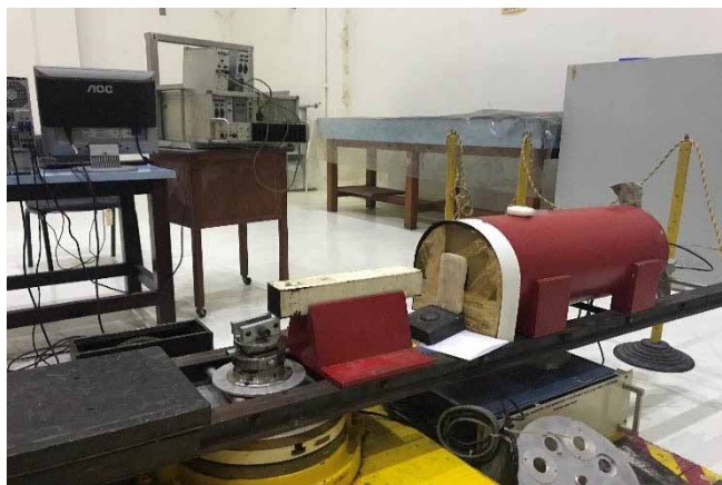
Fig. 3 – Estrutura montada para o experimento, utilizando a parafina borada como blindagem.
