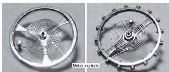
Figura 10 – Mecanismo de um relógio e seu acionamento: a mola espiral numa porta basculante e num relógio acionado por este tipo de mola. Vide Figs. (8), (9) e (10).
