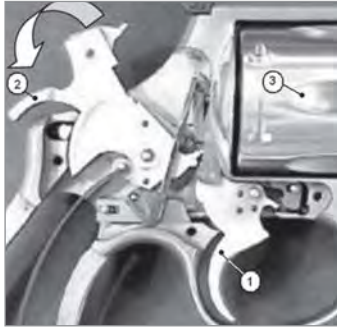
Figura 1 – Mecanismo de giro e disparo do sistema ação tipo revólver
