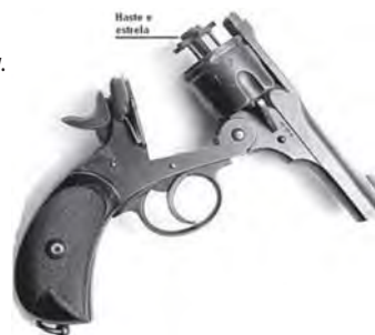
Figura 12 – Sistema de extração do revólver Webley. Fonte: (Disponível em: < http://serioussamfr.free.fr/armes.html > Acesso em: 20/09/2007)
