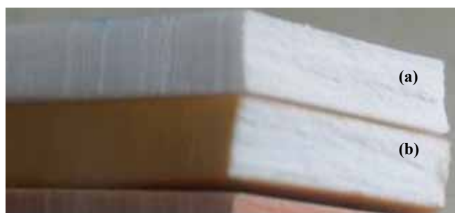
Fig. 2 - Aspecto macroscópico a "olho nu" da seção transversal da chapa do compósito de PVC: (a) "como recebido"; (b) irradiado UV por 240 h.
