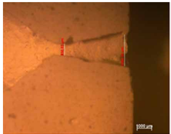
Fig. 9 - Imagem da cavidade interna da tubeira do micropropulsor.
