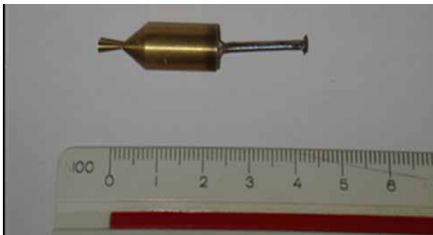
Fig. 2 - Matriz do micropropulsor em latão com haste para manipulação.
