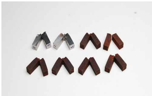
Fig 9: Corpos de prova após fratura no ensaio de Charpy.
