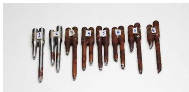
Fig 8: Corpos de prova após fratura no ensaio de tração.
