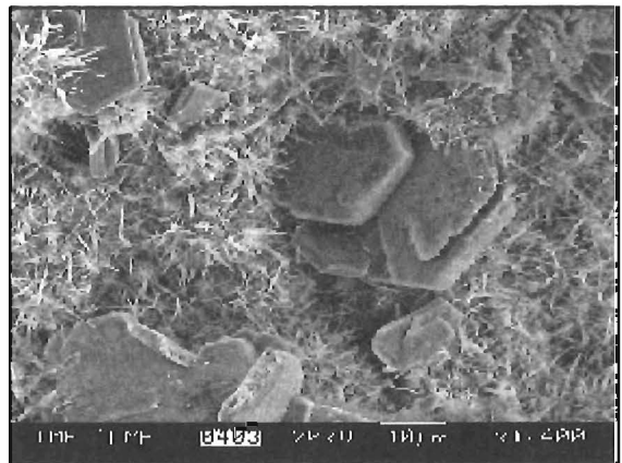
Figura 5: Micrografia (MEV) da pasta de CPIIE-32 aos 28 dias — fator A/C = 0,30 (1400X)
