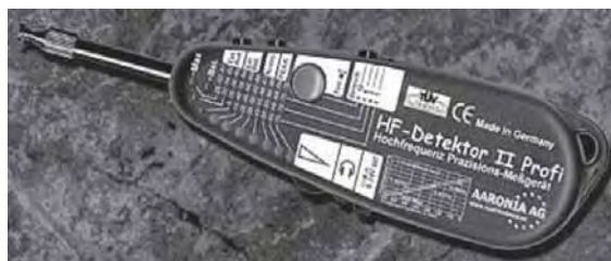
Figura 4 – Medidor HF-Detektor II Profi, da Aaronia, utilizado nas medidas em São Gabriel da Cachoeira – AM
