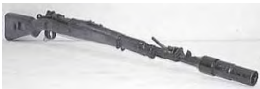
Figura 2 – Carabina alemã Mauser GEW 33/40 – 7,92mm (usada na Segunda Guerra Mundial) com o lançador de granada de bocal tipo copo fixado ao cano
