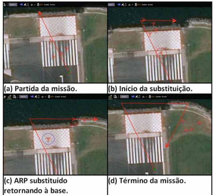
Fig. 8 – Resumo da tarefa realizada no estudo de caso. Em (a) podemos ver o líder sendo seguido. Na sequência (b) a ARP reserva parte para substituição da ARP com baixa energia. Após a substituição (c) a ARP substituída retorna à base para recarga. E, por fim, (d) a ARP líder termina seu trajeto e todos retornam à base.
