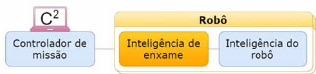
Fig. 2 – Estrutura arquitetural de uma missão com múltiplos robôs.
